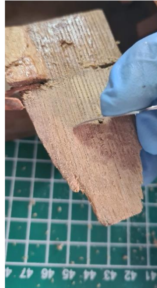
Figura 96 Remoción del residuo desprendido con espátula y bisturí
