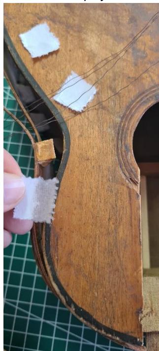
Figura 105 Fragmentos de papel japonés listos para adherirse en los puntos de encuentro interno entre tapa y aros
