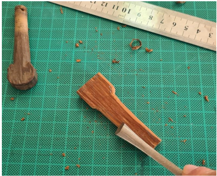
Figura 128 Ubicación de clavija elaborada en clavijero
