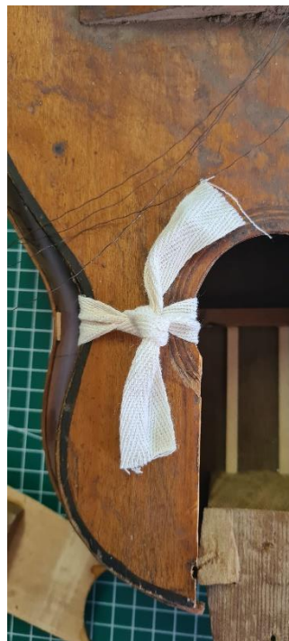
Figura 106 Amarre con cinta espiga para afirmar la adhesión
