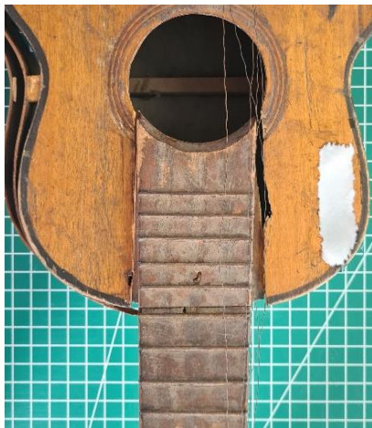
Figura 88 Detalle de fragmento de papel japonés preparado para consolidar fisura en tapa armónica
