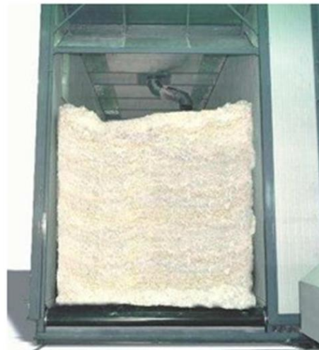
Figura 18 Interior máquina NODRIX (Silo de almacenaje)
