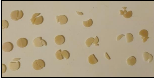
Figura 5.- Probetas fracturadas luego de prueba de compresión.
