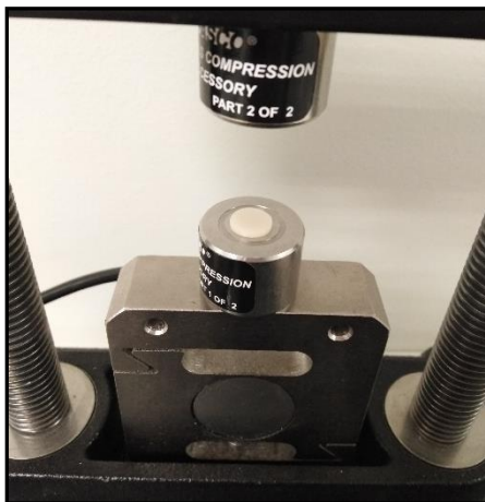
Figura 3.- Probeta en posición para realizar prueba de compresión.
