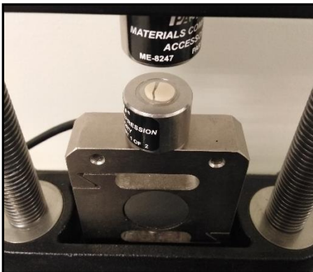
Figura 4.- Probeta fracturada luego de prueba de compresión.
