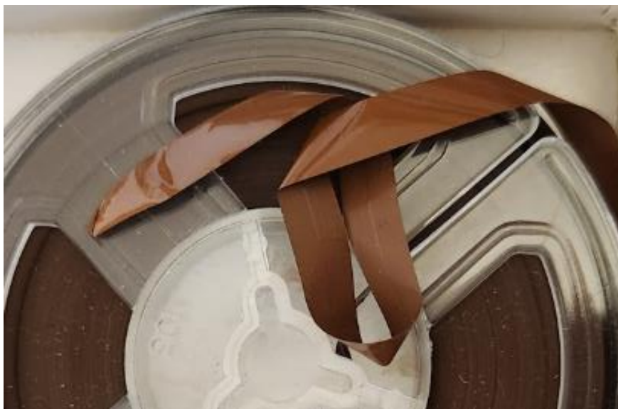
Figura 5. Cinta de carrete abierto que presenta deterioros de suciedad superficial y pliegues. Fuente: Elaboración propia
