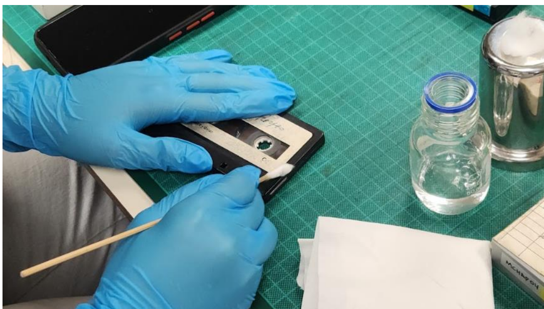
Figura 11. Limpieza de carcasa de un casete. Fuente: Elaboración propia
