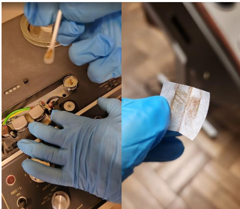
Figura 25. Limpieza de reproductor y de cinta antes de la digitalización. Fuente: Elaboración propia
