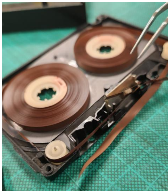
Figura 21. Casete abierto para intercambiar su cinta. Fuente: Elaboración propia
