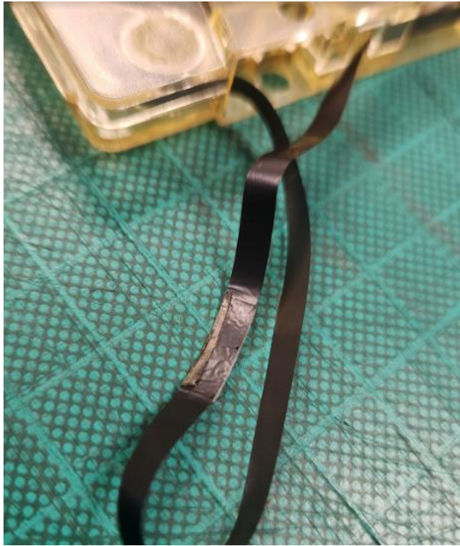
Figura 15. Empalme mal ejecutado de forma inadecuada. Fuente: Elaboración propia.
