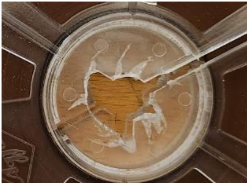
Figura 7. Carrete plástico con daño en su centro por manipulación inadecuada. Fuente: Elaboración propia
