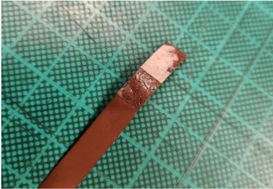
Figura 6. Restos de adhesivo en el extremo de una cinta open reel. Fuente: Elaboración propia
