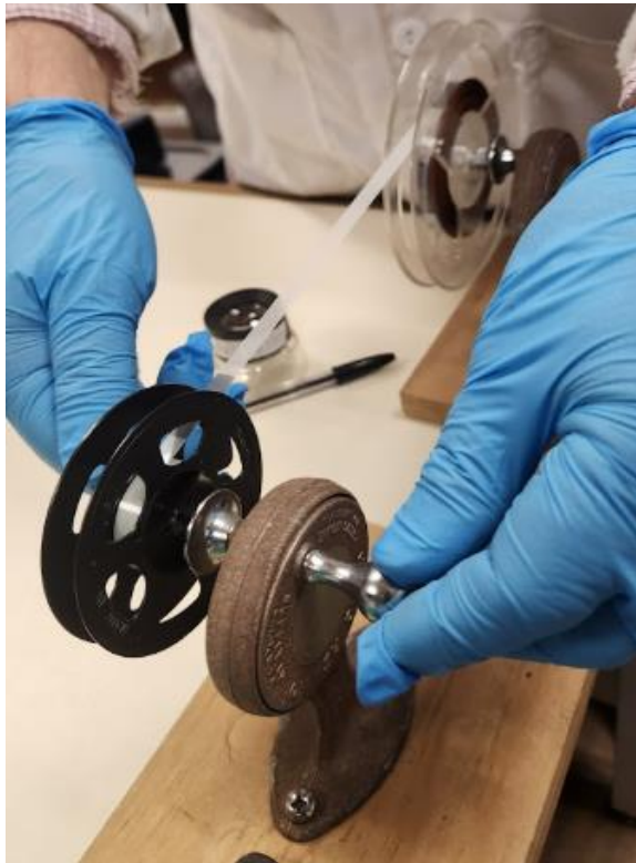
Figura 20. Rebobinador manual haciendo el intercambio de carretes. Fuente: Elaboración propia
