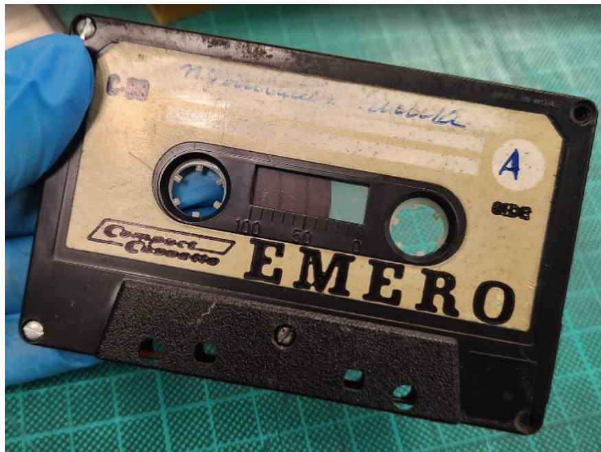
Figura 10. Casete con carcasa defectuosa dada la ausencia de tornillos en sus dos extremos inferiores. Fuente: Elaboración propia
