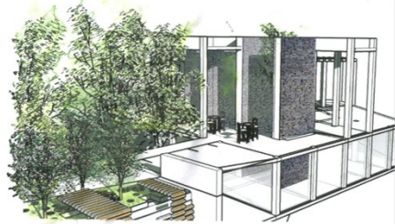
MUROS DE PIEDRA DISPUESTOS EN CONTRA LA RADIACION DE LA TARDE. MUROS RECOLECTORES DE AGUA CREAN CORTINAS DE AGUA.
