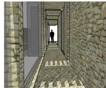
TRAGALUZ SUPERIOR: RECIBE LA LUZ DE LA MAÑANA Y LA INTRODUCE A LAS HABITACIONES Y A LA CIRCULACION
