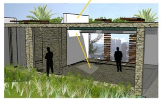
MURO HORMIGON BLANCO: SOBREPASA LA CUBIERTA DEL HOSTAL PARA REFLEJAR LA LUZ HACIA EL INTERIOR. ADEMAS ACTUA COMO ELEMENTO REPRESENTATIVO, MARCA LA SECUENCIA DE LAS HABITACIONES.
