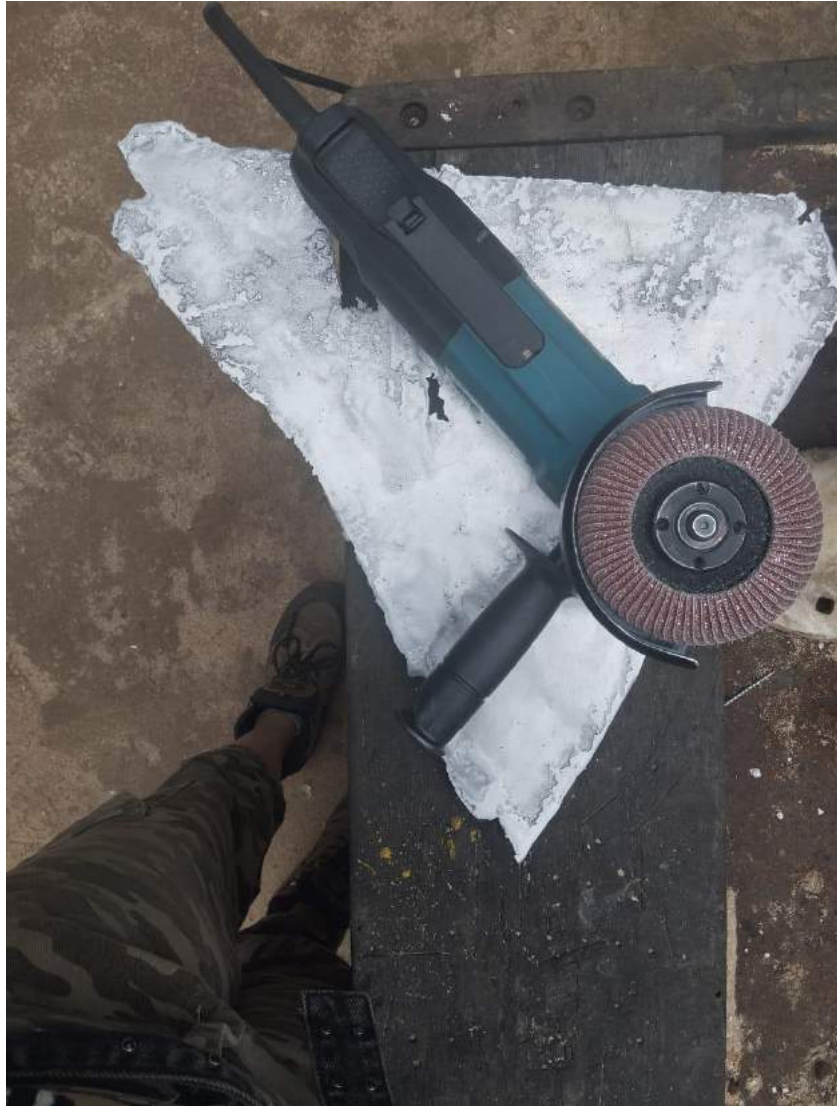
Figura 34: Registro fotográfico de esmeril y pulido de cara inferior de aluminio. 2023. Autoría propia.
