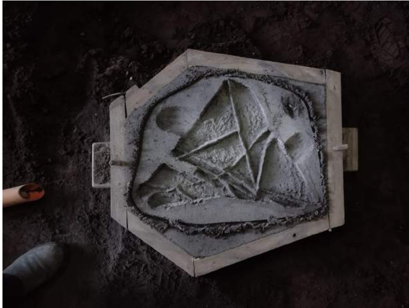
Figura 27: Registro fotográfico de molde en arena especial para fundir. 2023. Autoría propia.
