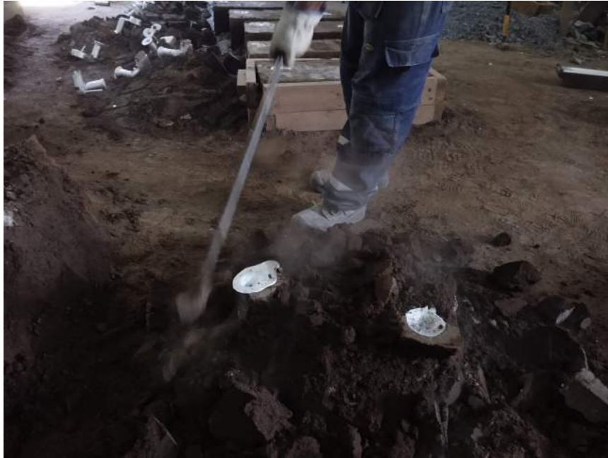
Figura 31: Registro fotográfico de la ruptura de la tierra. 2023. Autoría propia.
