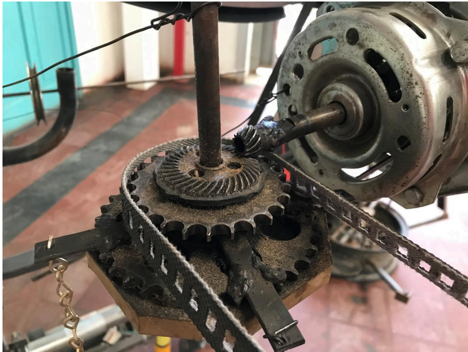
Figura 6: Registro fotográfico de mi autoría. Detalle del sistema con diferencial de auto (2024).
