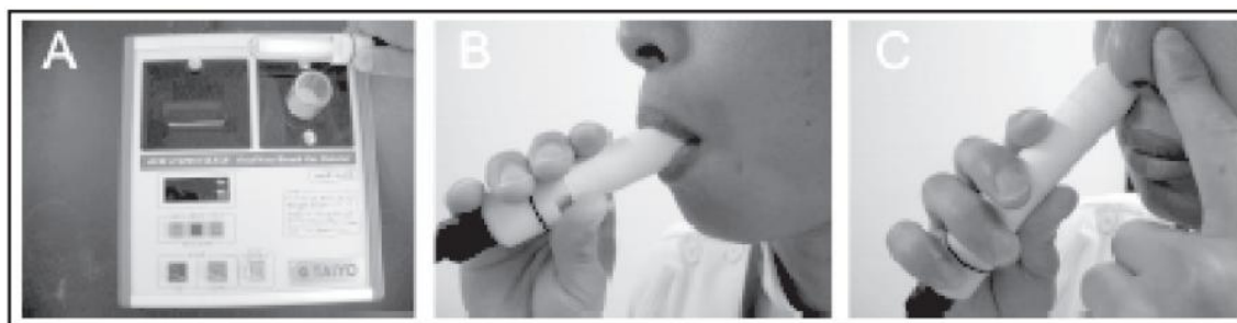
Fig 3. Nuevo monitor portátil de mal olor, de inspector B/B. (A) El tamaño del monitor es de 210 mm de alto por 230 mm de ancho por 80 mm de altura. (B) Medidor del gas oral y exhalado. (C)
