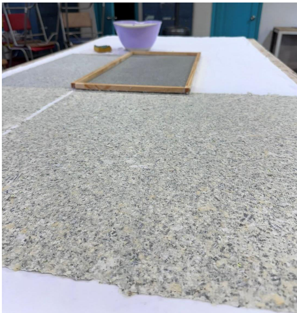
Figura 7: Proceso de armado del papel reciclado. Al estar aún mojado, se puede hacer un lienzo más grande que la matriz propia del bastidor que se esté utilizando. En este caso el bastidor es de 30 x 60 centímetros y como resultado tenemos un papel de 90 x 180 centímetros.
