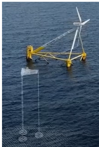
Figura 7. Ilustración del diseño submarino del prototipo X30: Tecnología TLP y SPM.
