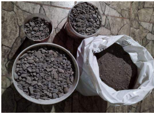
Figura 8: gravilla y arena de río para el Hormigón, 2023. Archivo privado
