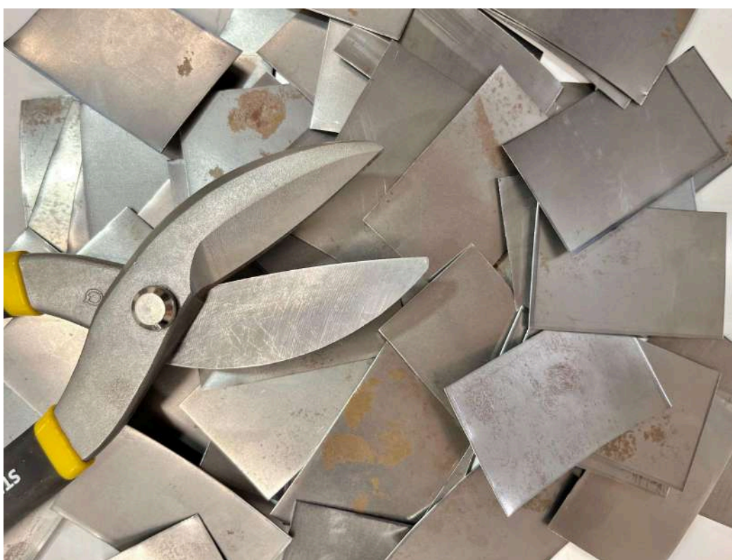
Figura 5: Registro fotográfico de mí autoría (2024). Transformación de plancha metálica al ser cortada generando módulos rectangulares de igual tamaño.
