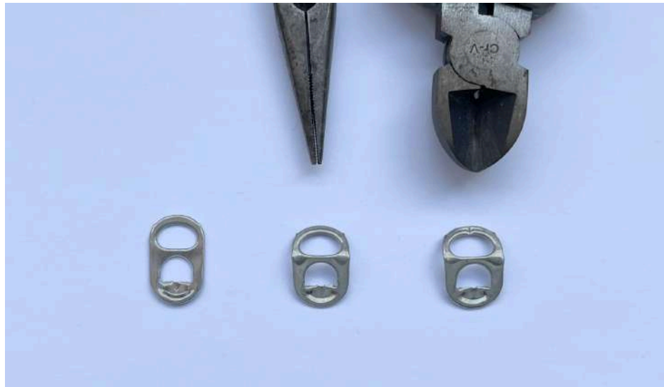
Figura 10: Registro fotográfico de mí autoría (2024). Secuencia de modificaciones que se generan con las herramientas (alicate y cortante) en las anillas, para que así puedan enlazarse unas con otras generando un tejido.
