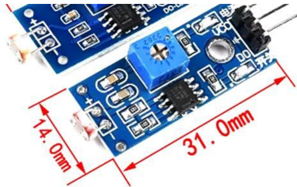
Figura 5.1: Sensor Fotosensible Lm393
