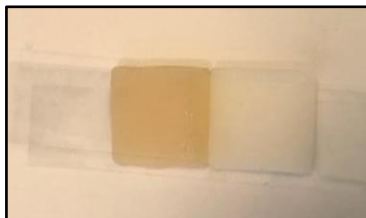
Figura 6.- Probeta lista para polimerizar con bandas de celuloide
