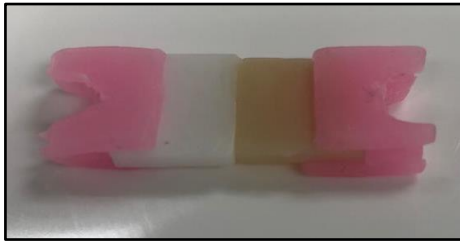
Figura 8.- Probetas con cera rosada en los extremos para confección de matriz.
