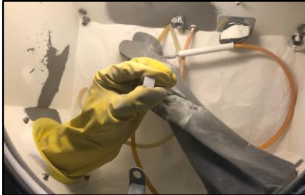
Figura 2.- Muestra de Zirconio. Arenado con óxido de Aluminio
