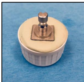
Figura 3.- Confección de matriz de silicona para muestras de resina.
