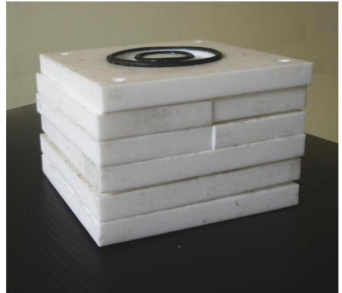
.moldes de teflón para **BORDE** que se rellenan con resina epóxica.
