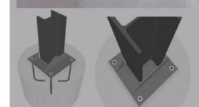
Consiste en un apoyo soldado en placa de anclaje con un elemento constructivo en que se ancle el pilar. El comportamiento de este apoyo equivale a un empotramiento perfecto.
