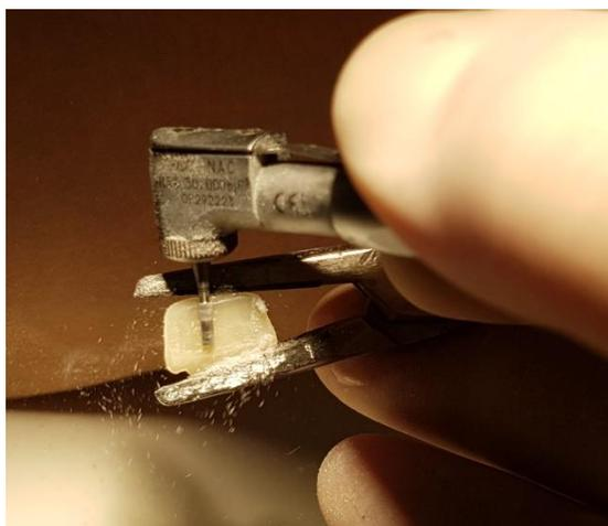
**Figura 22.** Preparación con baja velocidad y sin refrigeración (Subgrupo Bs).
