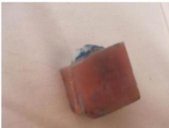
**FOTO 7** FOTO 7: PIEZA ENVUELTA EN ACRILICO DE POLIMERIZACIÓN LUEGO DE SER SOMETIDA AL PROCESO DE TERMOCICLADO.
