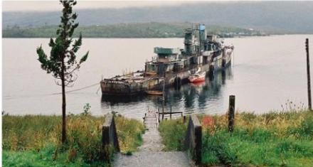
En la localidad de Puerto Edén, se utiliza un viejo carguero a modo de muelle flotante, que sirve para amarrar las embarcaciones que llegan, este muelle no se conecta a tierra y el casco de acero del barco se ha deteriorado por la falta de mantención
