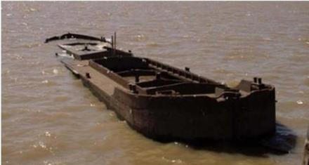
Los cascos de ferrocemento, sin importar las inclemencias del tiempo o la falta de mantención, mantienen su integridad por mucho más tiempo.
