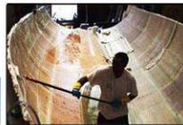
luego de sacar las costillas provisorias el casco se enfiar por el interior, despues solo quedan infinitas horas de lija y la pintura
