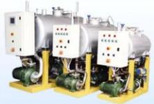
Para el tratamiento de aguas servidas se utilizará el sistema Techni Biocon, que purifica los desechos para ser descargados al mar bajo la norma más estricta existente
