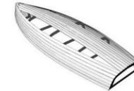
las cuadernas se recubren en laminas de espuma que se clavan a estas, las laminas pueden tener un machihembrado parecido al de la madera, lo que facilita su union y continuidad en las curvas
