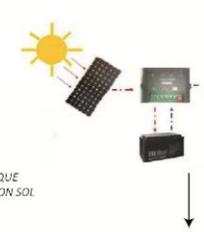
LUMINARIAS SOLARES CON CPU DEPENDIENDO DEL GASTO SE UTILIZA PARA QUE SE ENCIENDAN A UN CIERTO PORCENTAJE EN UN RANGO DE HORA ESPECIFICO, CON EL FIN DE AHORRAR LA ENERGIA ALMACENADA EN LAS BATERIAS.
