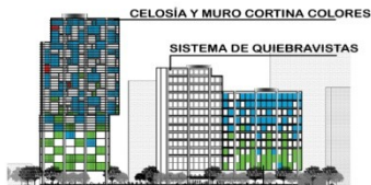
CELOSÍA Y MURO CORTINA COLORES SISTEMA DE QUIEBRAVISTAS SISTEMA DE QUIEBRAVISTAS Y PERSIANAS DE COLORES EN LOS PRIMEROS NIVELES EL CONTROL SOLAR SE PRODUCE A TRAVÉS DE ÁRBOLES DE HOJA CADUCA.
