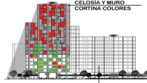
CELOSÍA Y MURO CORTINA COLORES SISTEMA DE QUIEBRAVISTAS FACHADA CON VENTANAS Y VACÍO PARA PRODUCIR VENTILACIÓN NATURAL.
