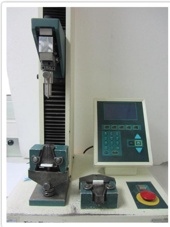
**Fig. 23** Máquina de ensayos universales Tinius Olsen modelo HSK – S
