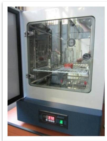
**Fig. 18** Estufa a 37° C y 100% de humedad, con recipiente con las muestras
