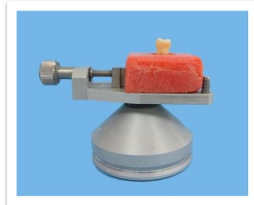
**Fig. 6** Plataforma analizadora con cubo de soporte de acrílico y pieza dentaria fijada
