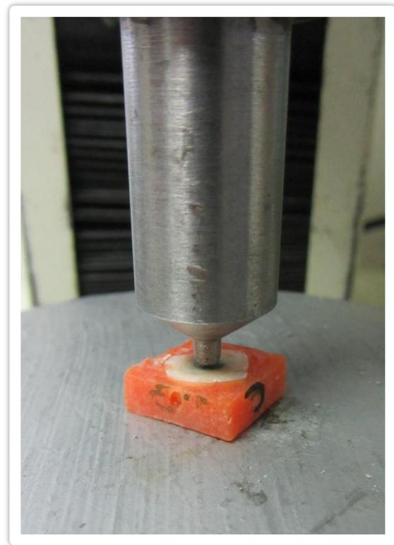
**Fig. 24** Detalle del procedimiento de empuje de las restauraciones
