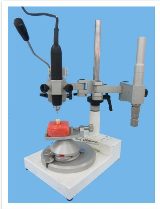
**Fig. 11** Micromotor eléctrico montado en paralelizador de fresado con preparación en posición.
