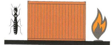
LA CORAZA DE 2MM DEL CONTENEDOR RESISTE LA MANIPULACION Y LAS CONDICIONES CLIMATICAS ADVERSAS , SIN EMBARGO NECESITA UNA BUENA AISLACION TERMICA Y ACUSTICA, ESTE PODRIA RESULTAR SU GRAN DEFECTO
