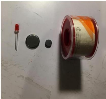
Componentes: led + pila + imán + cinta
