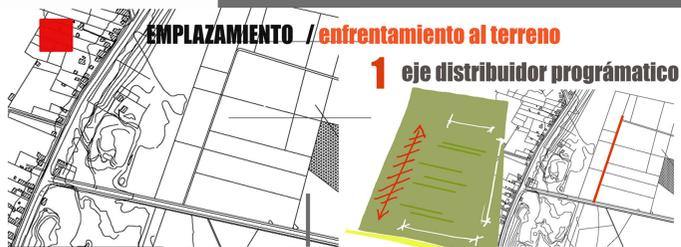
Eje longitudinal que recorre el terreno en sentido N-S, abarcando su extensión longitudinal y liberando superficie para alcanzar la mayor productividad del terreno
