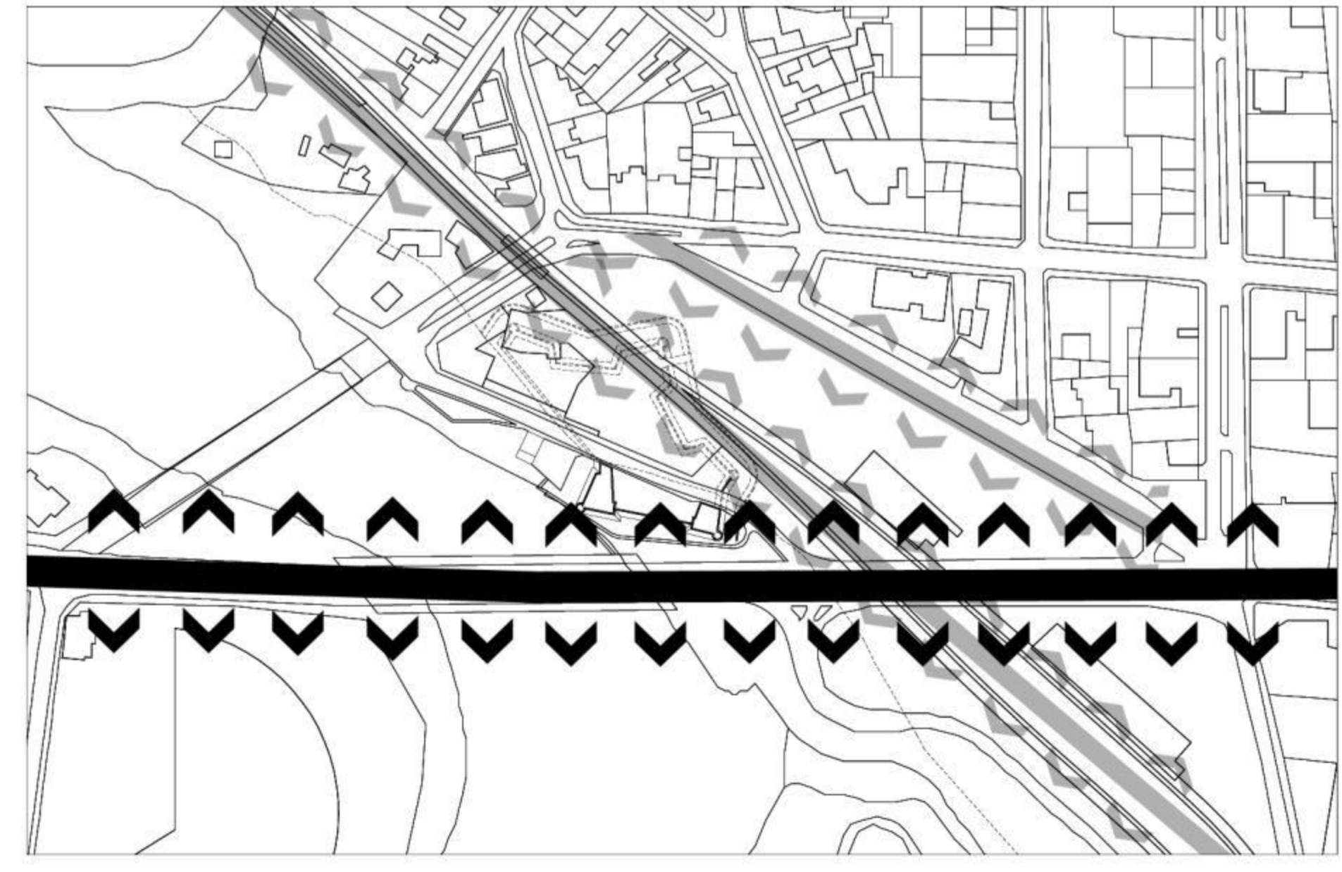
EL NUEVO PUENTE SAN PEDRO ES EL PRINCIPAL CAUSANTE DEL RUIDO EN EL LUGAR, ADEMÁS DE SER UN RUIDO CONSTANTE. LA LÍNEA DEL TREN TAMBIÉN ES CAUSANTE DE RUIDO, PERO NO ES CONSTANTE.
