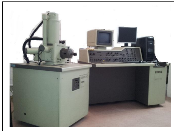
Fig.6 Se muestra una imagen del MEB utilizado en este estudio, confeccionado en Alemania Occidental, marca Zeiss, modelo 940.
