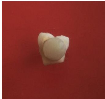
Figura 2: Cilindro de resina sobre la cara constituida por tejido dentinario y esmalte del cuerpo de prueba
