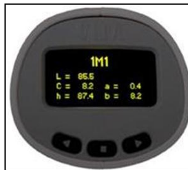
Figura 7. Ejemplo de los valores L^* , a^* , b^* , C^* , h^\circ obtenidos de un tercio del diente.
